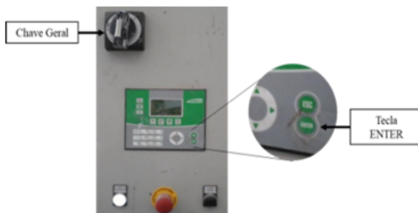
Imagem 01. Identificação da Chave Geral e Tecla ENTER no painel do Sistema de Banho e Secagem.
