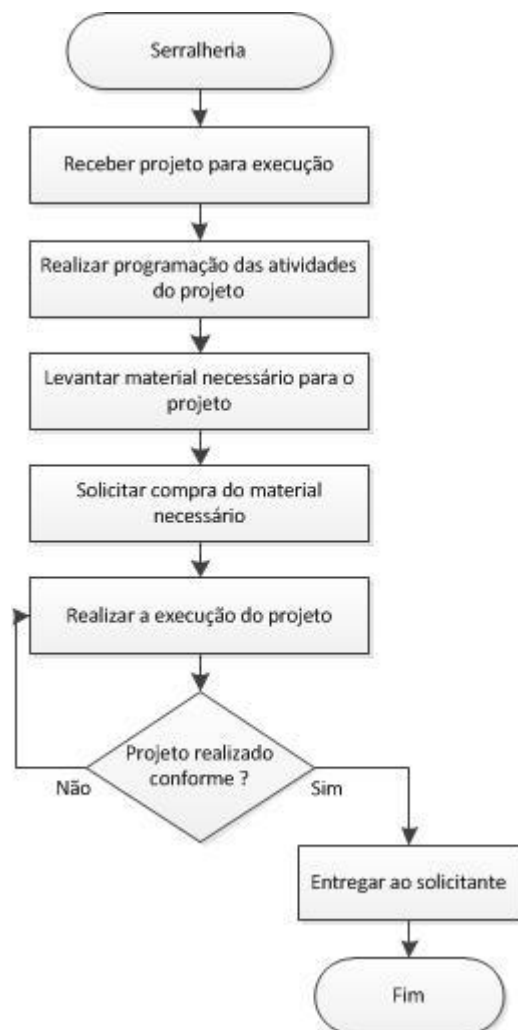
Ilustração 05: Fluxograma da serralheria
